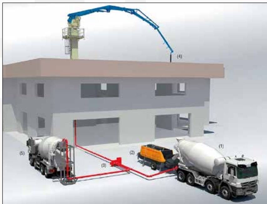
Slika 11. Princip rada i sastavni dijelovi stacionarne pumpe za beton: 1.mikser za opskrbu betonom, 2.stacionarna pumpa;3.zatvarač za regulaciju protoka;4.razastirač za beton;5.mikser za povrat betona
